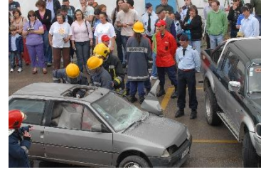
Corte de pilares do veículo
